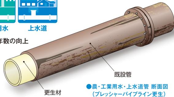
●農・工業用水・上水道管 断面図 (プレッシャーパイプライン更生)
